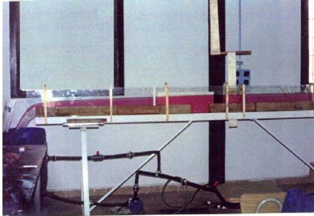
Figura 1: Pequeño canal hidráulico que se utilizó para los ensayos.
