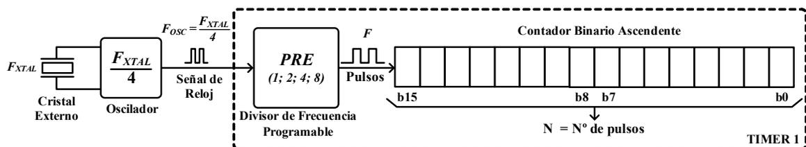
Figura 3: Diagrama en bloques simplificado del temporizador TIMER1.
