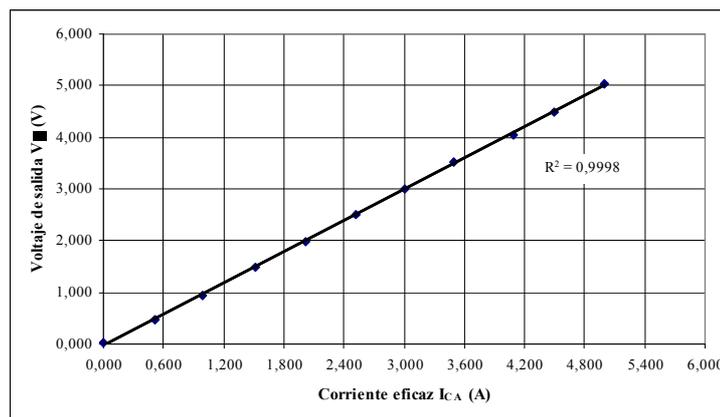
Figura 6: Relación salida-entrada para el circuito convertidor  $I_{CA}-V_{CC}$ .
