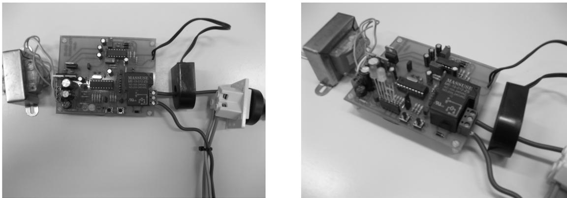
Figura 7: Fotos del controlador inteligente de carga (prototipo).
