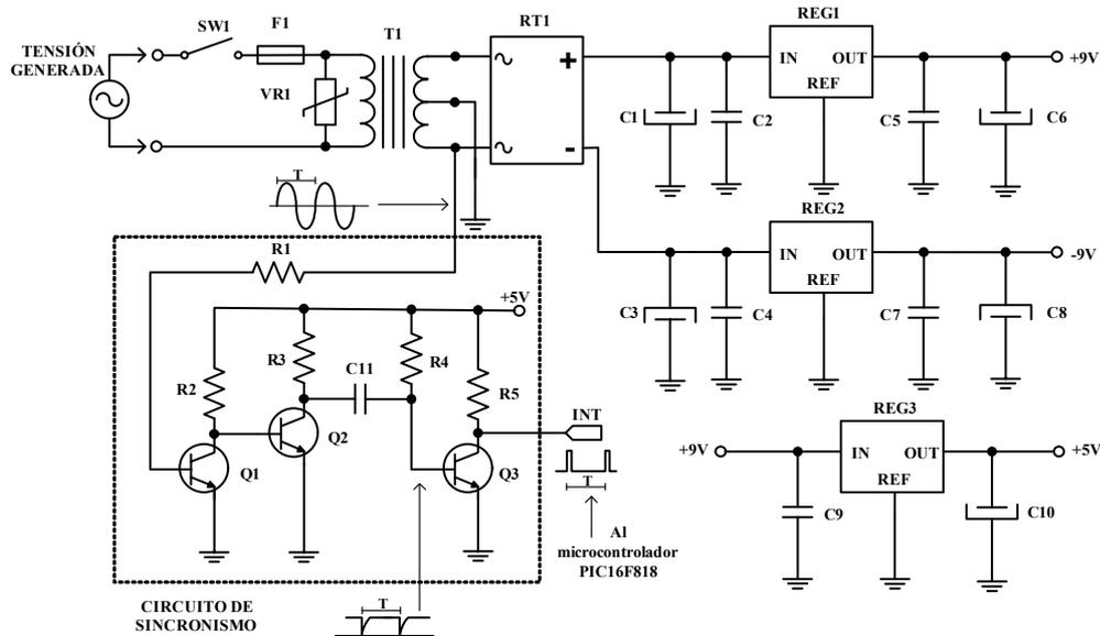
Figura 2: Circuito de sincronismo y fuente de alimentación del controlador de carga.
