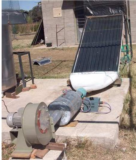
Figura 2: Fotografía del colector solar, ventilador y recinto de calefacción del aire que ingresa al colector.
