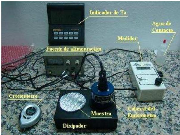
Figura 2: Foto del equipo de medición y esquema del emisómetro
