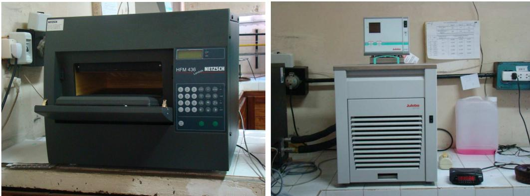
Figura 8: Foto del equipo medidor de flujo de calor, utilizado para determinar la resistencia térmica de las cámaras de aire.
