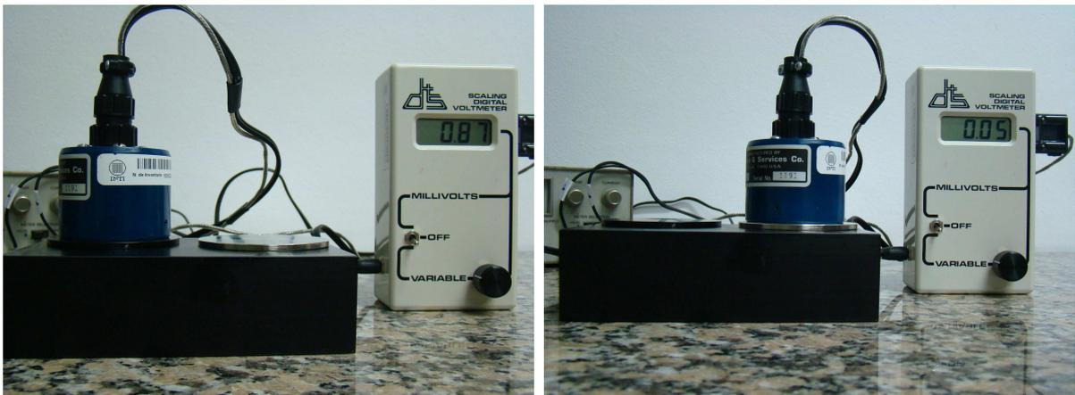
Figura 3: Ubicación de los patrones de alta y baja emitancia sobre el disipador y sus respectivas mediciones.
