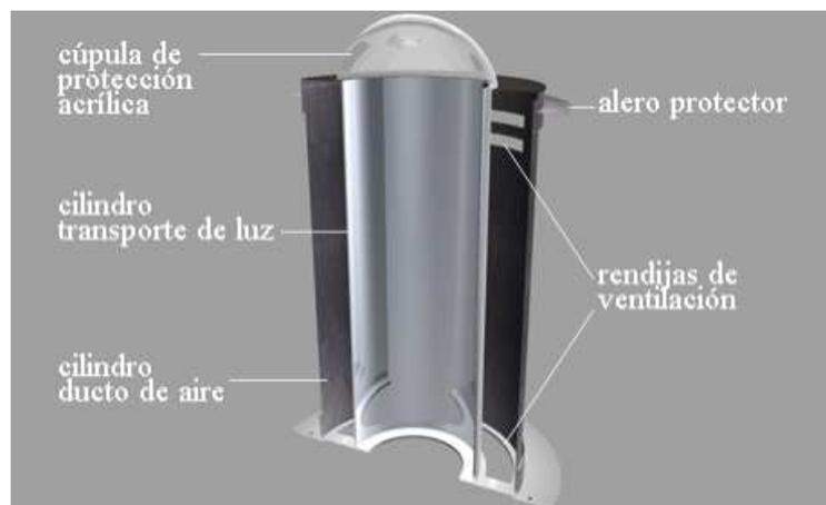
Figura 2: Corte longitudinal esquemático
