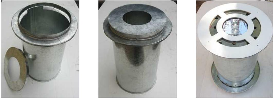
Figura 4: De izquierda a derecha; tubo de ventilación; zona de colección y zona de emisión del dispositivo
