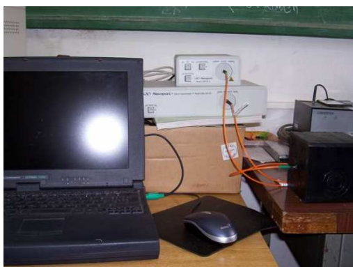
Fig 1: Sistema espectrométrico (PC, espectrómetro, fuente UV/visible, fibra óptica, porta muestra)
