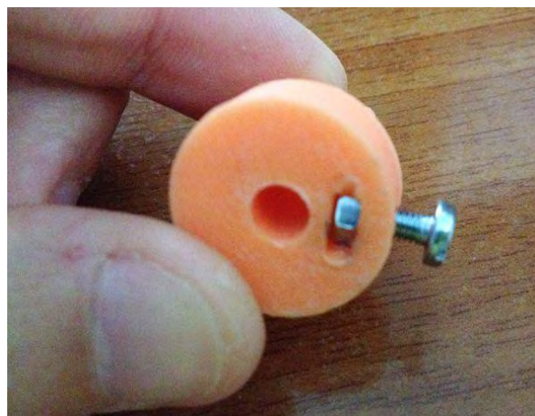
Figura 51: Engranaje con tornillo métrico 3 y tuerca métrica 3 empotrada
