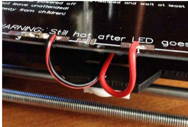
Figura N°68: fijación de cables de alimentación a la ficha de empalme
