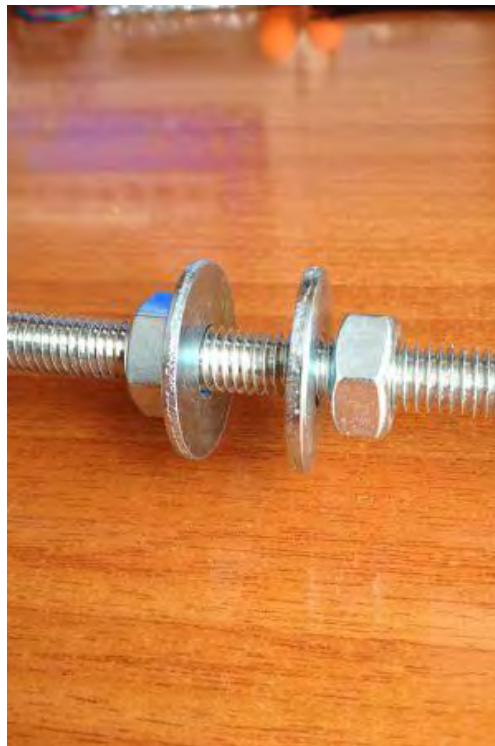
Figura N°25: Unión de base que posteriormente se usara para unir el marco con la base
