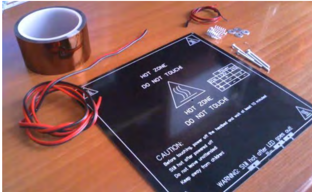
Figura N°61: Elementos necesarios para montar la cama caliente
