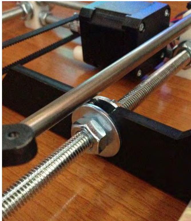
Figura N°47: Introducción de varilla e la base del marco.
