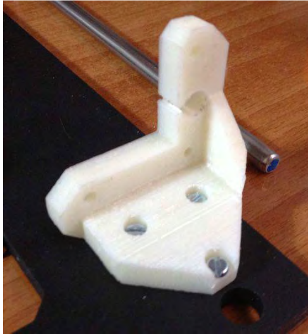
Figura N°38: Pieza de plástico para fijar el motor
