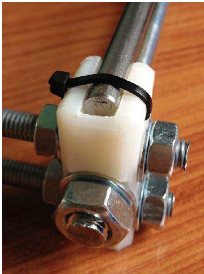
Figura N°27: Unión de varilla lisa en la parte superior de la pata.
