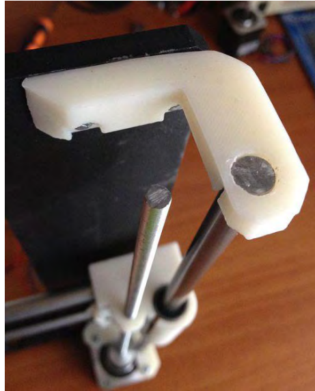
Figura N°43: Montado de varilla métrica 5 visto desde arriba.
