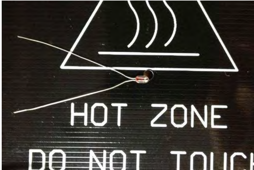
Figura N°64: termistor y centro de cama caliente
