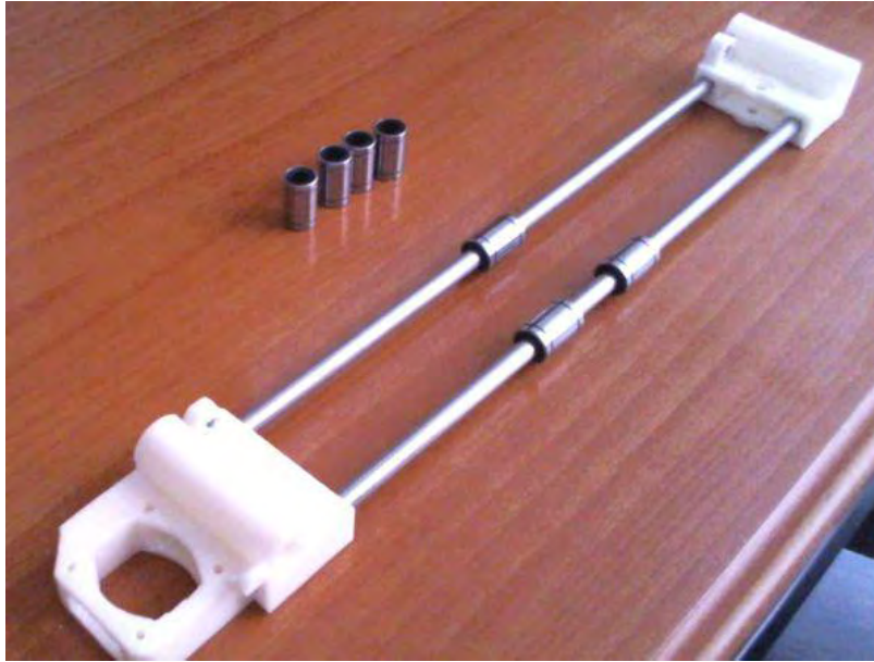
Figura N°34: Unión de piezas mediante varillas lisas
