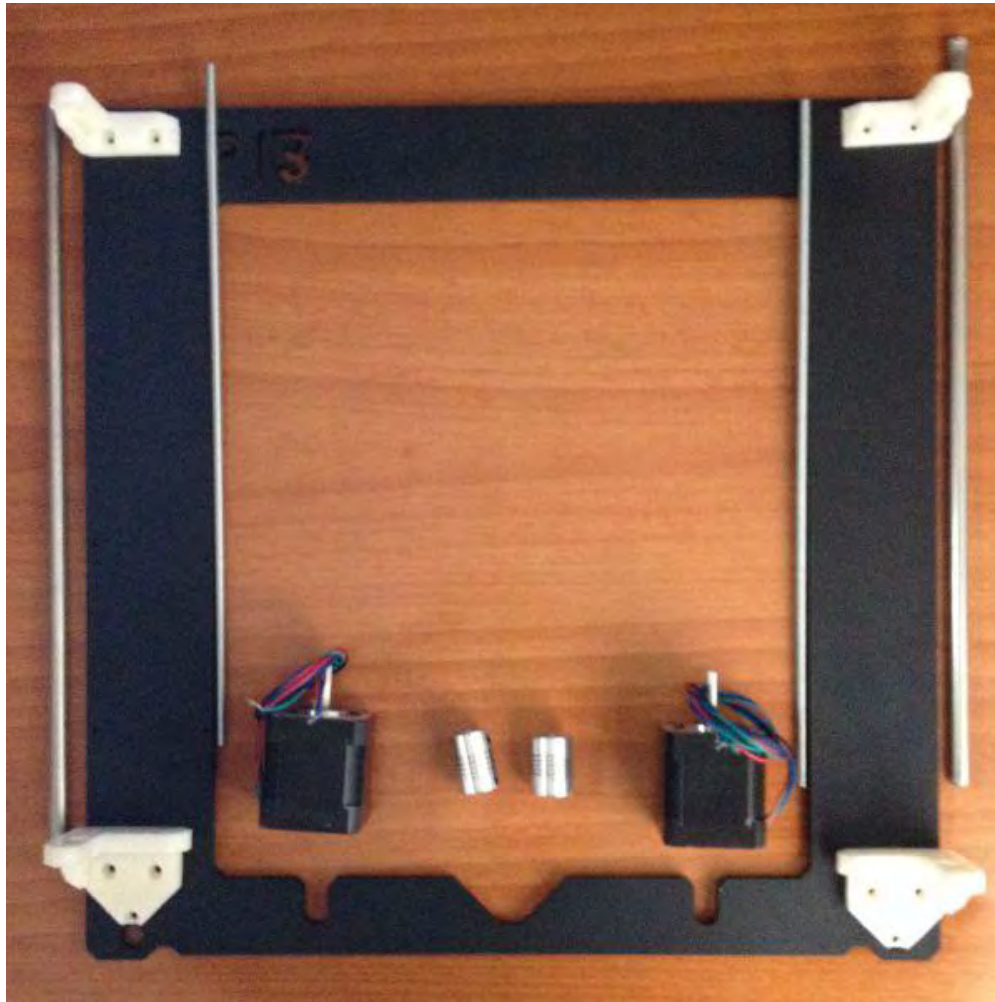
Figura N°37: Elementos necesarios para montar el marco.
