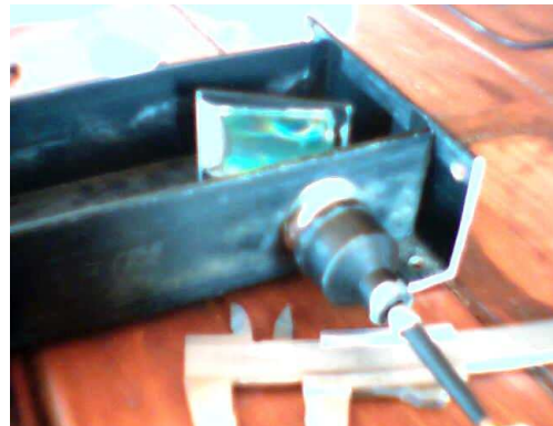
Figura 2b: Detalle: red de difracción y salida del monocromador
