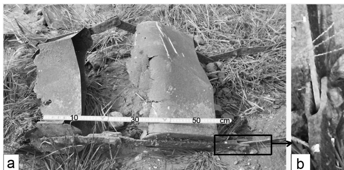
Figura 8. a: Cangilones semienterrados; b: Detalle de la articulación de la cadena de cangilones.
