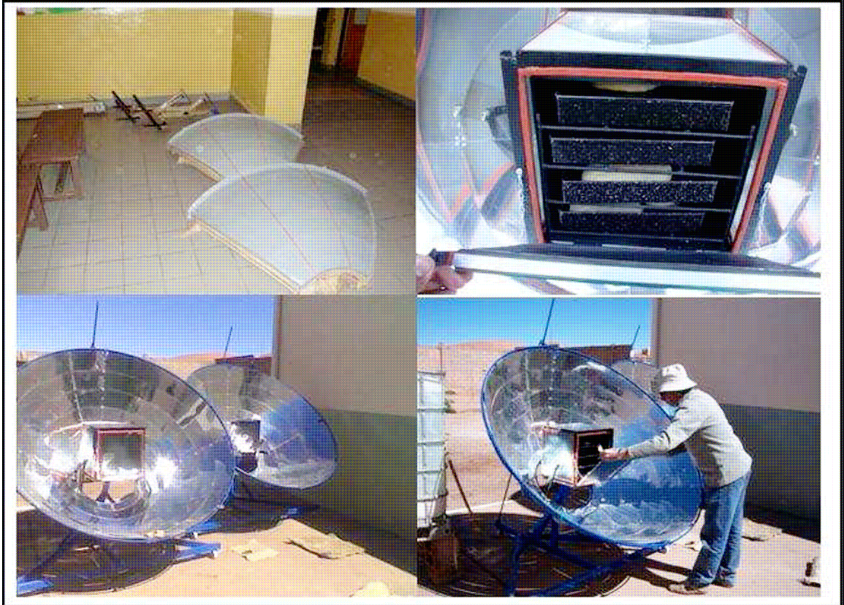
Figura 2: cocinas solares desarmadas; horno con pan; las dos cocinas cocinando.
