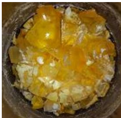
Figura 2.24.- Gel seco con cristales de sílice en formación
