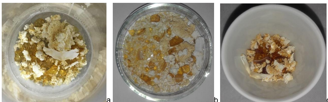
Figura 3.38.- a) Formación del gel húmedo partir del agregado a la mezcla de la cáscara de limón (LCa); b) Formación del gel vítreo con inicio de formación de cristales de la muestra LCa c) Gel vítreo seco LCa
