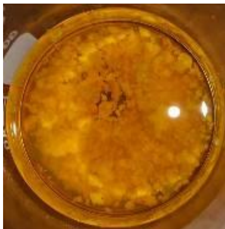
Figura 2.25.- Mezcla inicial de la muestra de sílice con cáscara de naranja (NCa)
