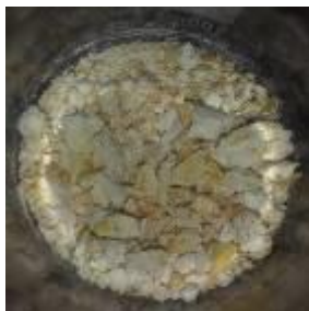
Figura 2.36.- Gel seco con cristales de sílice en formación
