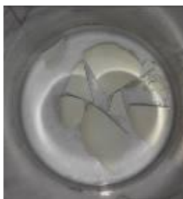
Figura 4.14.- Gel seco con cristales de sílice en formación
