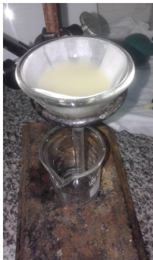
Figura 2.8.- Zumo de limón (LZ) sometido a filtración por gravedad
