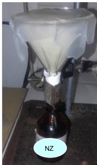
Figura 2.22.- Zumo de naranja (NZ) sometido a filtración por gravedad
