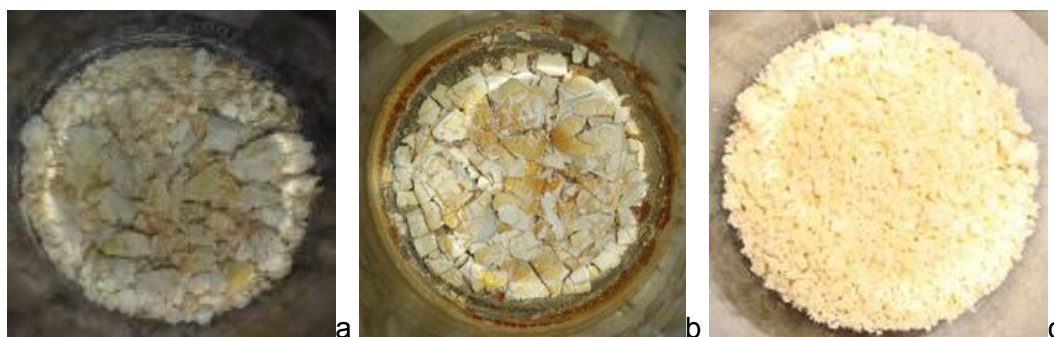
Figura 3.127.- Gel seco con inicio de formación de cristales de las muestras: a)MCa; b) MEETCax y c) MCax
