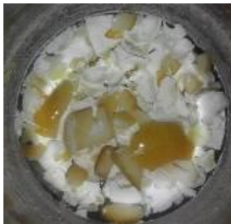
Figura 2.33.- Gel seco con cristales de sílice formados
