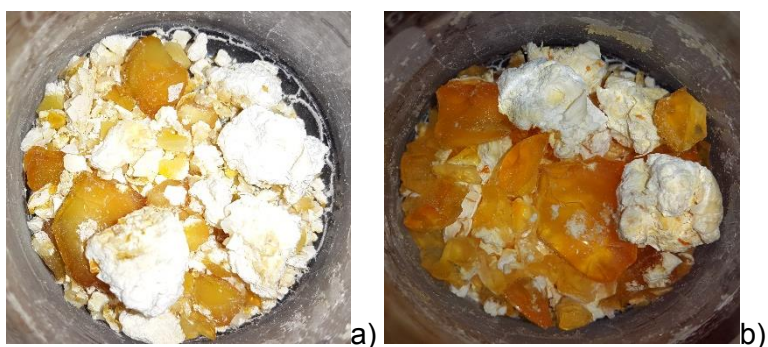
Figura 3.73.- a) Formación del gel húmedo partir del agregado a la mezcla de naranja completa; b) Formación del gel vítreo con inicio de formación de cristales de la muestra de Naranja Completa (NC)
