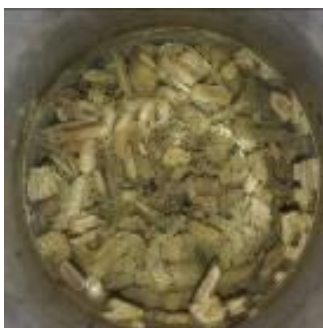
Figura 4.28.- Gel seco con Mate Usado (MaU)
