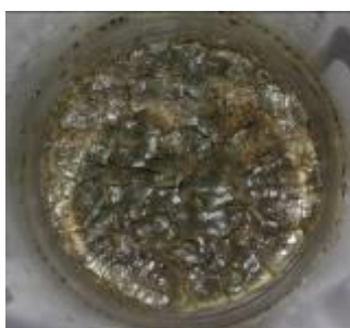
Figura 4.12.- Gel seco con cristales de sílice formados
