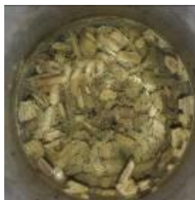
Figura 4.15.- Gel seco con cristales de sílice en formación
