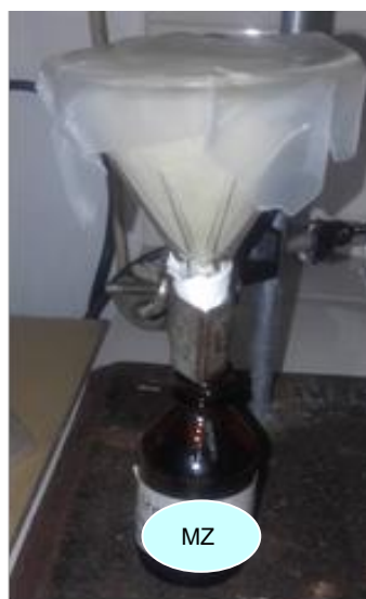
Figura 2.34.- Zumo de mandarina (MZ) sometido a filtración por gravedad
