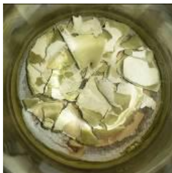
Figura 4.18.- Gel seco con cristales de sílice en formación
