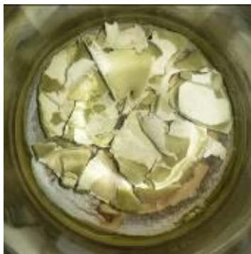
Figura 4.41.- Gel seco de la muestra de sílice (MaEEt) a partir de Extracto Etanólico de Yerba Mate Lixiviada
