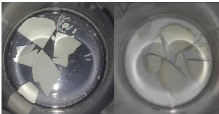
Figura 4.27.- Gel seco a partir del Zumo de Mate Nuevo (MaZ)
