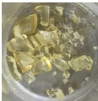
Figura 3.62.- Gel seco con inicio de formación de cristales de la muestra LCax
