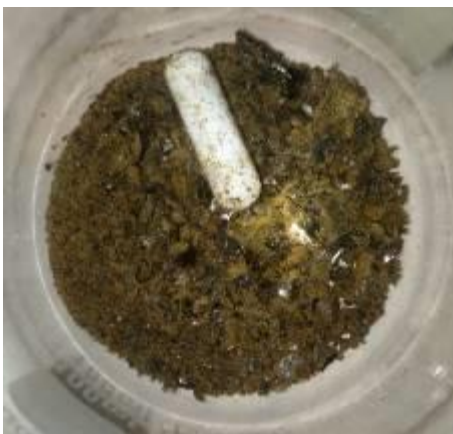
Figura 4.19.- Gel seco con cristales de sílice en formación
