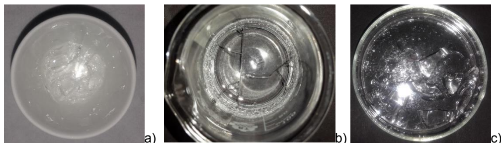
Figura 3.1.- a) Formación del gel húmedo; b) Formación del gel vítreo con inicio de formación de cristales catalizados a partir de ácido acético; c) Gel vítreo seco
