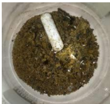
Figura 4.42.- Gel seco de la muestra de sílice (MaCax) a partir de Yerba Mate Lixiviada
