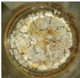
Figura 2.39.- Gel seco con cristales de sílice en formación
