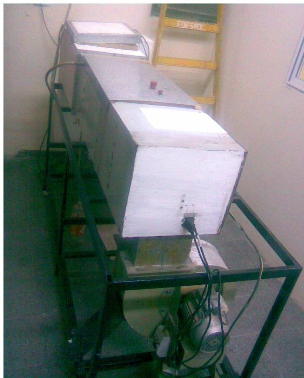
Figura 7: Foto del equipo experimental destinado al desarrollo de la experiencia de laboratorio de aire húmedo
