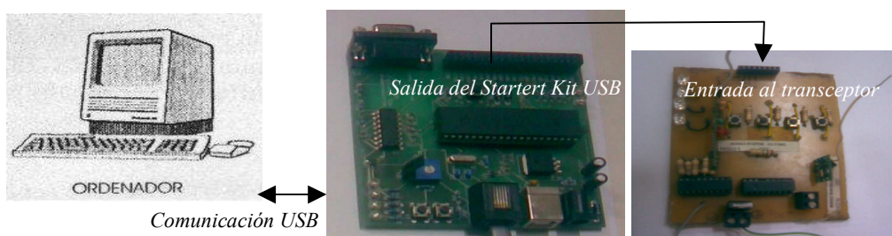
Figura 5: Se visualiza una PC, el Starter Kit USB y el tranceptor configurado como emisor
