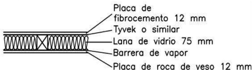
Figura 3. Puente térmico en construcción de madera.
