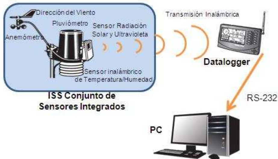
Figura 2: Esquema de Interconexión entre los sensores y los diferentes dispositivos hasta llegar a la PC.
