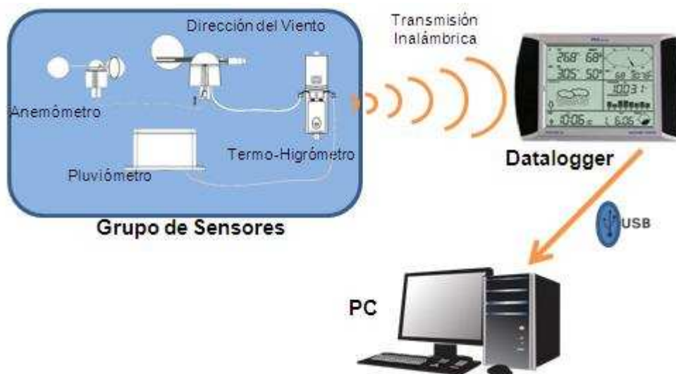
Figura 3: Esquema de Interconexión entre los sensores y los diferentes dispositivos hasta llegar a la PC.
