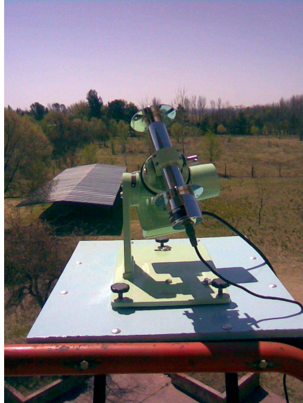
Figura 2: Instalación Pirheliómetro en la terraza del edificio
