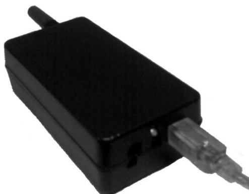
Figura 5. Módulo GPRS con comunicación serial USB
