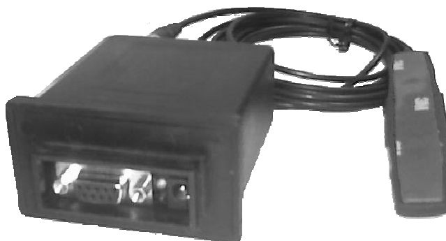
Figura 4. Módulo GPRS con comunicación serial RS-232
