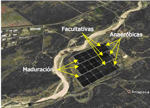
Figura 1. Imagen satelital del sistema de lagunas de estabilización de la Ciudad Capital de Catamarca.
