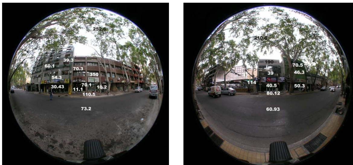
Figura 10: Mediciones de luminancias para la Fachada Sur (Izquierda) Fachada Norte (Derecha) del CVU 16m.
