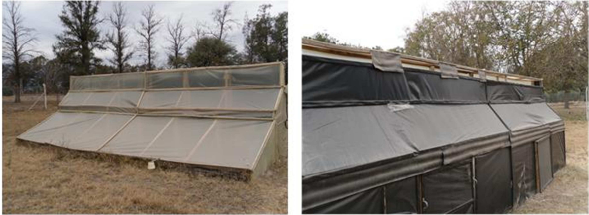
Fig. 2. Vista frontal y posterior del secadero tendalero solar con torre central
