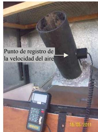
Figura 3b. Detalle del acople a la salida del colector
