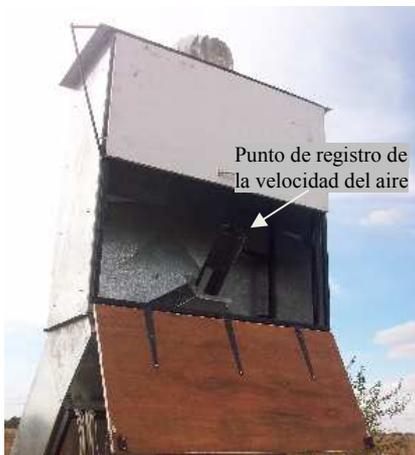
Figura 3a. Dispositivo cónico a la salida del colector
