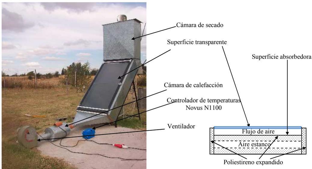
Figura 1a. Sistema ensayado
