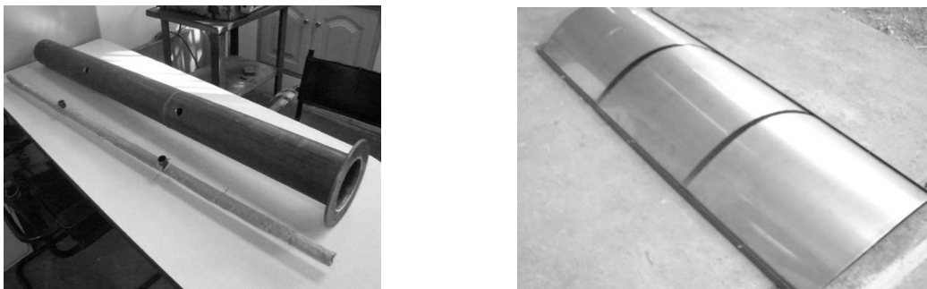
Figura 2: Algunos componentes del equipo solar (Colector y espejo)
