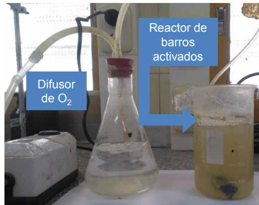
Figura 2-10. Esquema del montaje experimental realizado para ensayo de biodegradación
