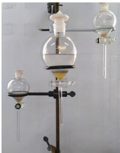
Figura 2-7. Embudos de separación de vidrio usados para la extracción de los hidrocarburos presentes en las muestras, en la imagen se diferencian las dos regiones (fracción acuosa y el solvente de extracción)
