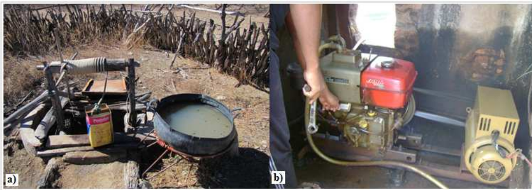
Figura 3: Métodos de extracción de agua utilizados por los habitantes de la región semiárida brasileña: a) alternativa manual y b) por medio de moto-generador a diesel.
