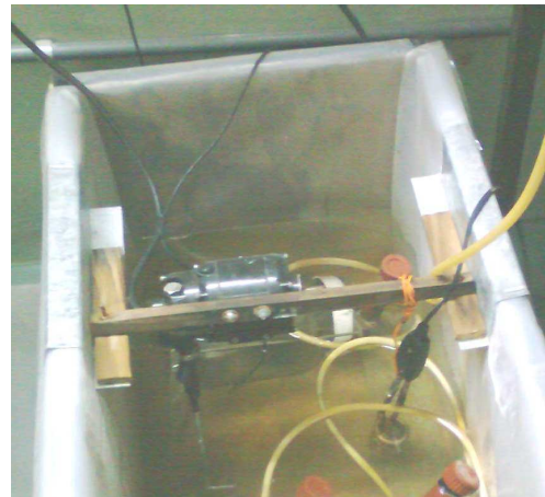
Figura 3: a) A la izquierda: parte de la unidad de generación de biogás. Sobre la pared el tablero de control. b) Detalle de la cuba donde se sumergió el BD-A junto al sensor, calefactor y agitador componentes del control automático de la temperatura del agua.
