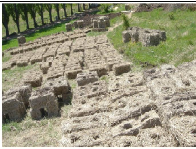
Figura 2b: secado de bloques
