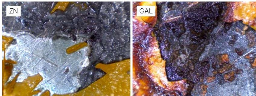
**Figura 9.** Fotografías tomadas con microscopio óptico (50X) en muestras expuestas 42 días en CNS en el borde de una ampolla levantada con un elemento cortante.
