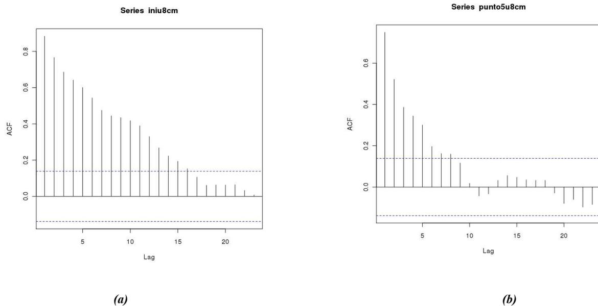
**Figura 2:** función de autocorrelación de datos para cada punto de medida.
