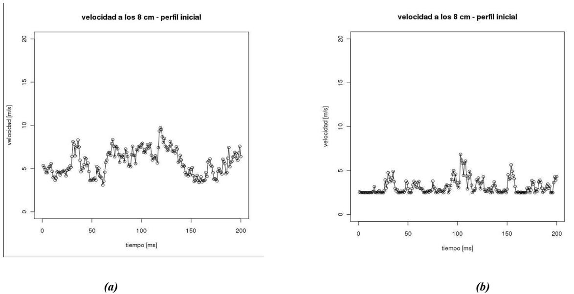
**Figura 1:** valores de velocidad de aire en un túnel de viento en dos puntos separados espacialmente. Ambos puntos de medición se sitúan a 8 cm de la base del túnel y se encuentran a lo largo del mismo eje.
