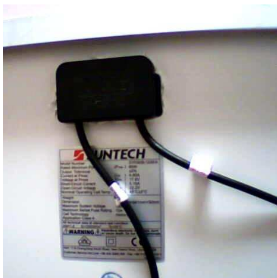
Figura 3: Detalle de la caja de conexiones.
