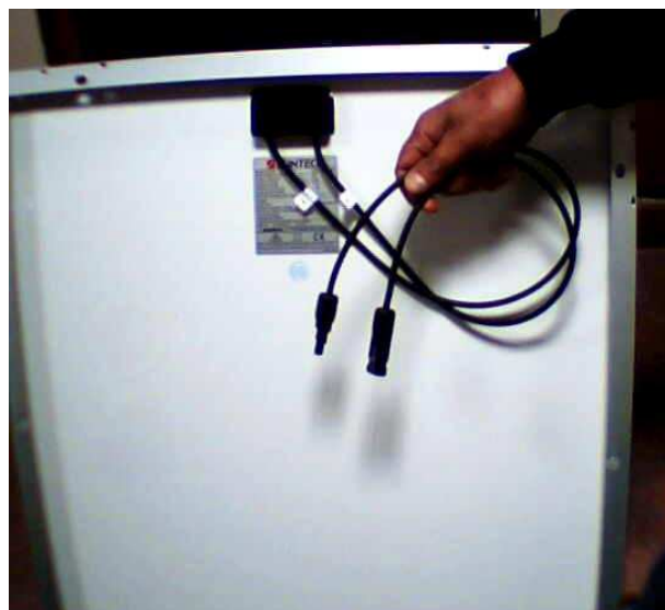
Figura 4: Detalle cables de conexión de un panel.
