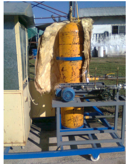
Figura 2: Esquema del circuito de recirculación y foto del tanque de agua presurizada y bomba de recirculación
