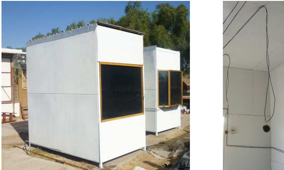
Figura 3: a) Fotos de los Módulos experimentales. b) Sensores en el espacio interior.
