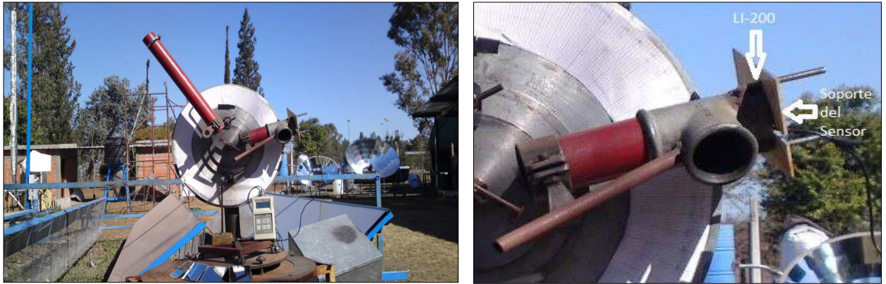
Figura 4: a) Fotografía del equipo de medida. b) Tubo que contiene el sensor de radiación.
