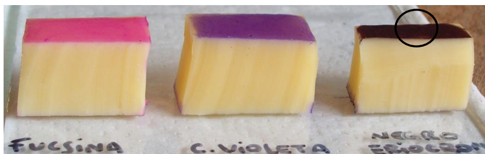
Figura 2. Fotografías de trozos de quesos recubiertos con películas dopadas con diferentes colorantes
