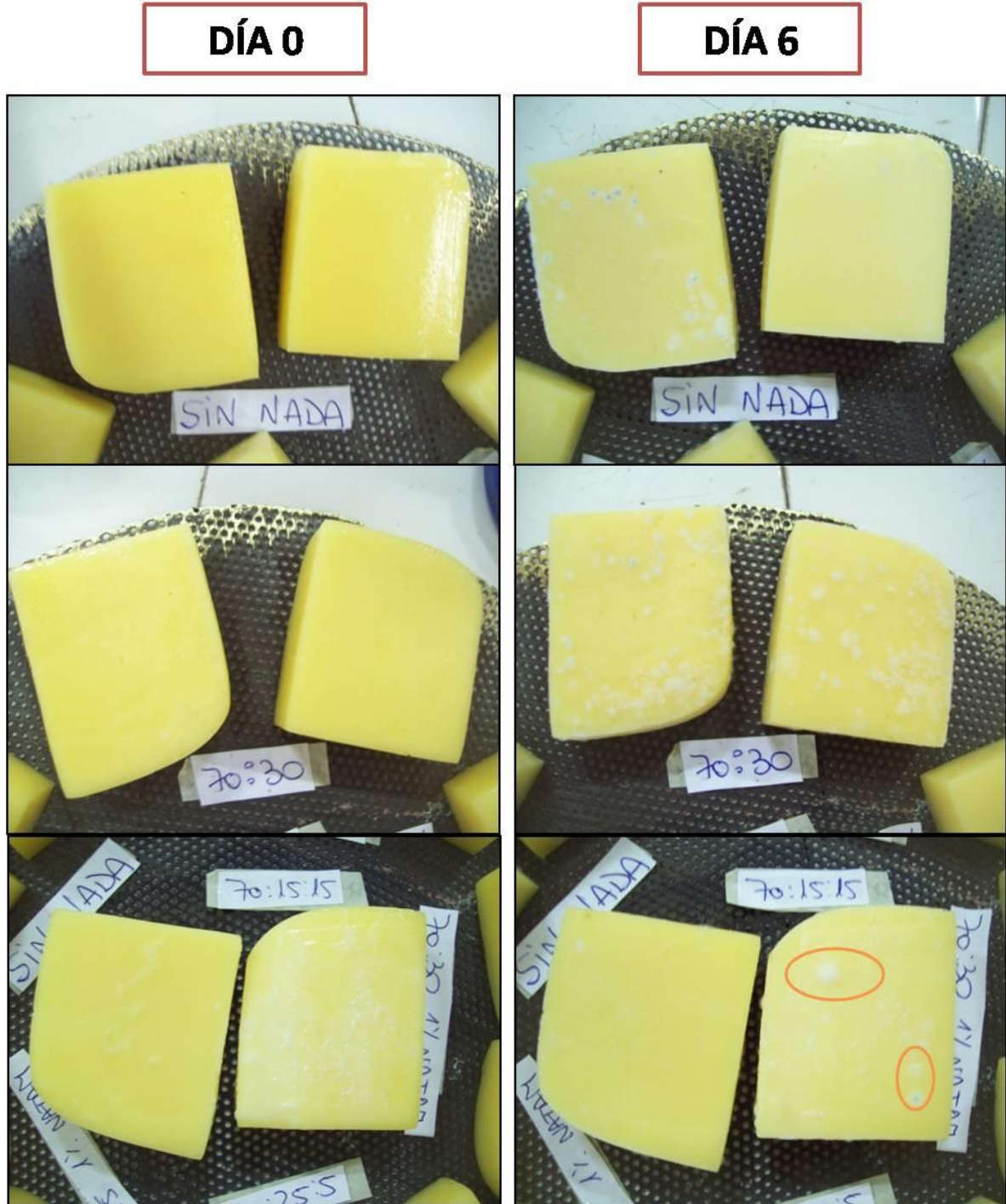
Figura 6. Quesos control sin recubrimiento y quesos con recubrimiento Alm/PVA 70:30 y Alm/PVA/PU 70:15:15 al comienzo del ensayo (izquierda) y luego de seis días de almacenamiento (derecha).
