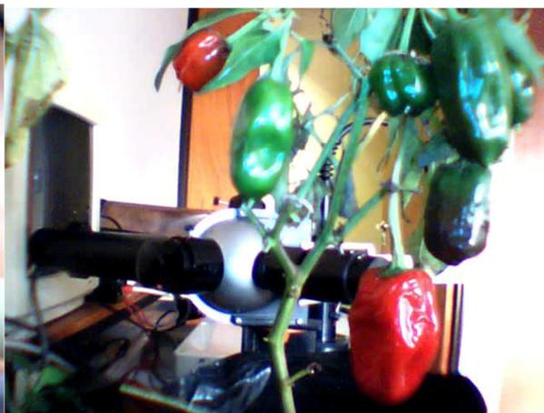
Figura 2: Medida de reflectancia con esfera integradora.
