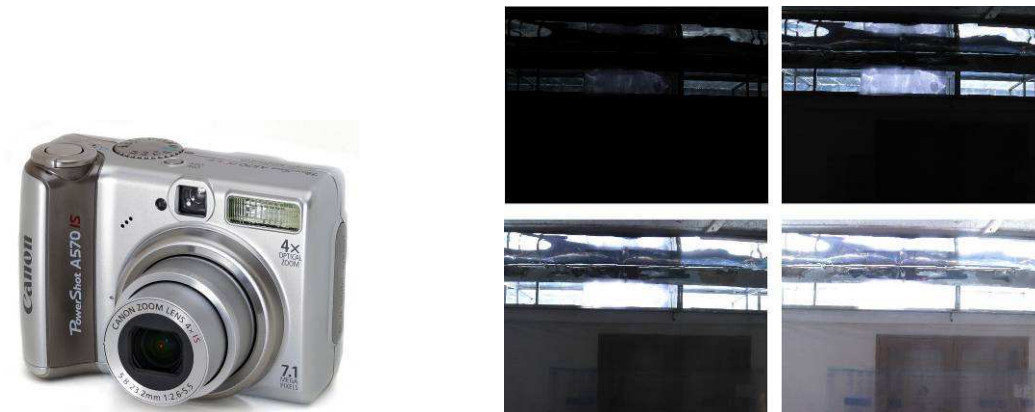
Figura 3: Izquierda, modelo de cámara utilizado; Derecha, muestra de fotografías tomadas con diferentes velocidades de obturación.
