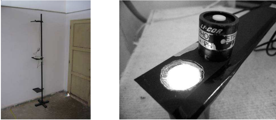
Figura 2: Equipamiento utilizado; Columna con alturas pre-fijadas y sensor fotométrico LI-210 SB.
