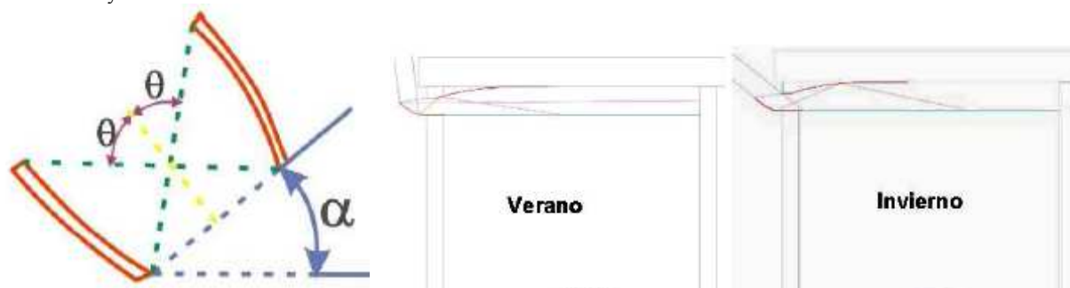
Figura 2: Izquierda, esquema del SPIN utilizado; Derecha, graficación de la trayectoria de rayos
