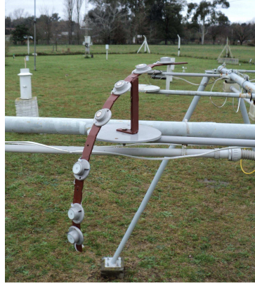
Figura 1: Disposición de los sensores para medir PAR en planos inclinados.
