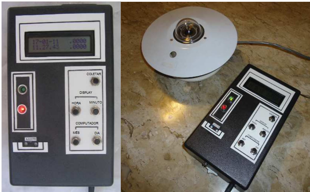
Figura 1 – Vista frontal do coletor de dados e o sensor para medição da radiação global.
