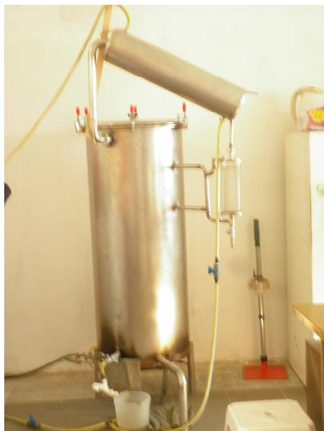
*Figura 2a: Equipo de destilación*
