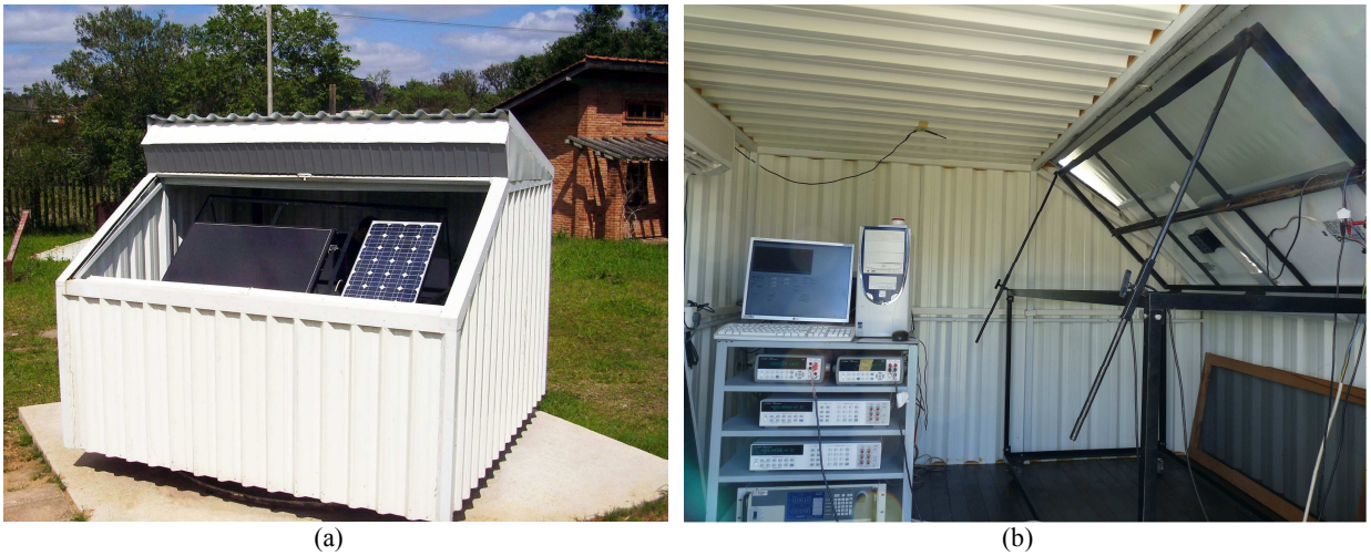
Figura 1: Câmara condicionada giratória utilizada para ensaios de dispositivos fotovoltaicos, (a) vista externa e (b) vista interna.
