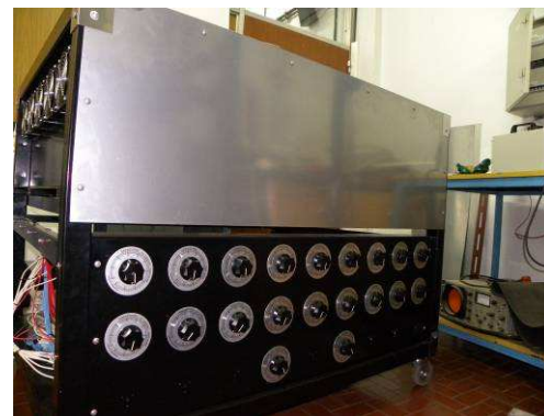
Figura 4: a) Etapa de montaje de los Autotransformadores, b) Tablero de control de los Autotransformadores del Simulador.
