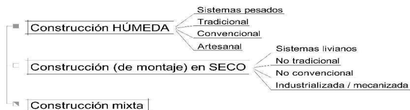
Figura 1: Delimitación de técnicas constructivas.
