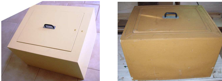
Figura 3: vista exterior de la caja térmica nueva (izq.) y la usada 3 años (der.).
