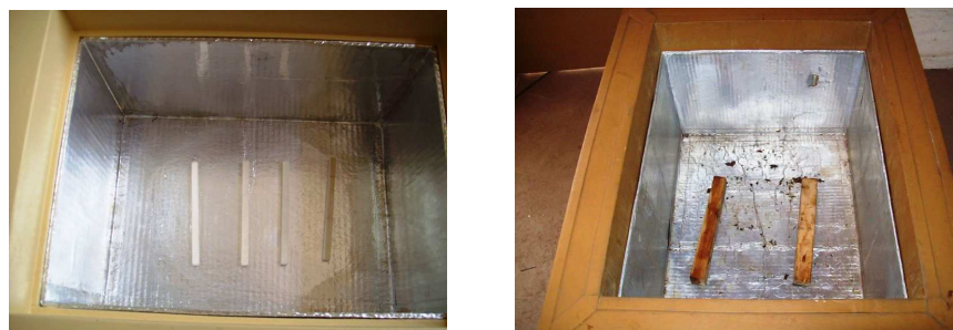
Figura 4: estado de la barrera radiante interior y los soportes para la caja nueva (izq.) y usada (der.).
