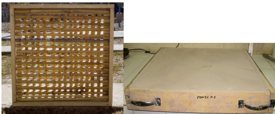
Figura 1: Armado de las muestras de quincha: entramado interior y muestra final revocada.
