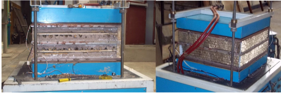
Figura 2: Disposición de los paneles en las maquinas de placa caliente en el INTI para el ensayo de transmitancia térmica
