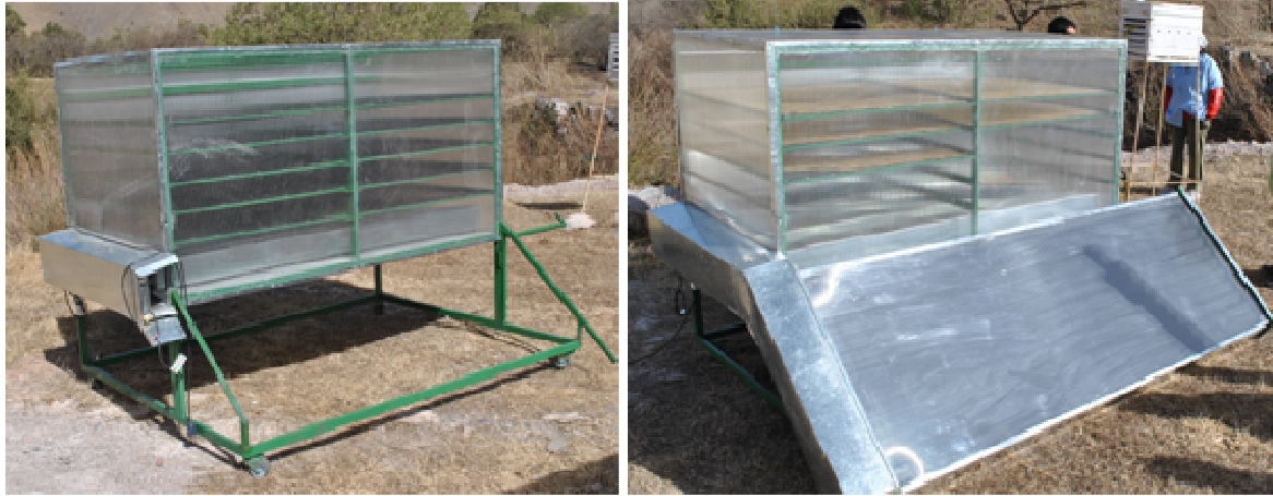
Figuras 2 y 3: Ensamblado y aspecto final del secador, donde se observa carga parcial de producto
