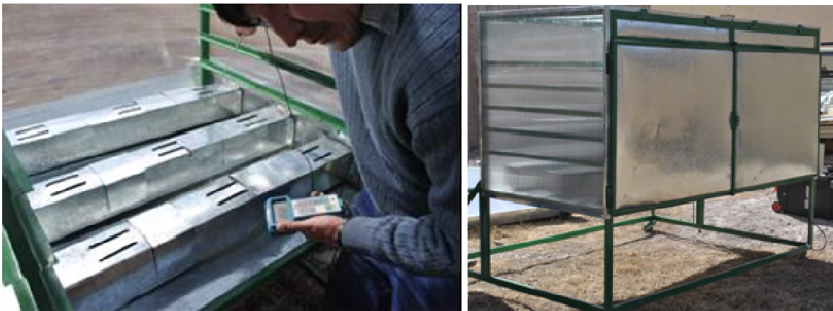
Figuras 4 y 5: Ductos de salida del aire hacia el interior del secador. Cara sur, donde se aprecian las puertas de acceso
