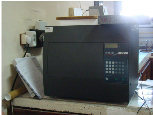
Figura 4: método del medidor de flujo de calor
