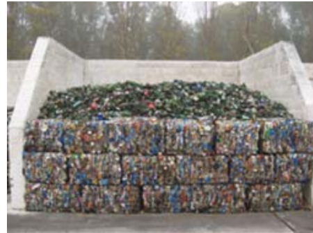
Foto 15: Acopio de vidrio molido y fardos de hojalata
