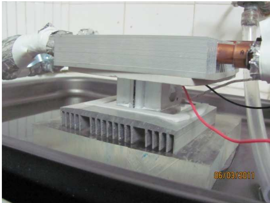
Figura 3. Celda con el sistema de refrigeración y calefactor. Las superficies de intercambiador son comerciales y vinieron con la celda.
