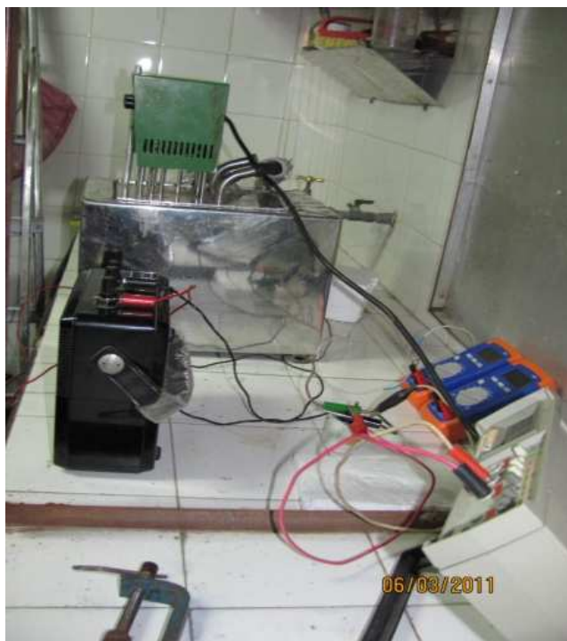
Figura 4 muestran el arreglo experimental usado para determinar el coeficiente peltier-Seebeck
