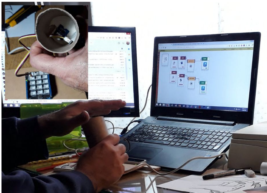
Figura 2: Demostración del caso Reproductor de Audio: construcción y prueba de boceto con hardware (con Arduino, sensor LDR y acelerómetro) y modelo de bloques en Cuaderno de Pluma
