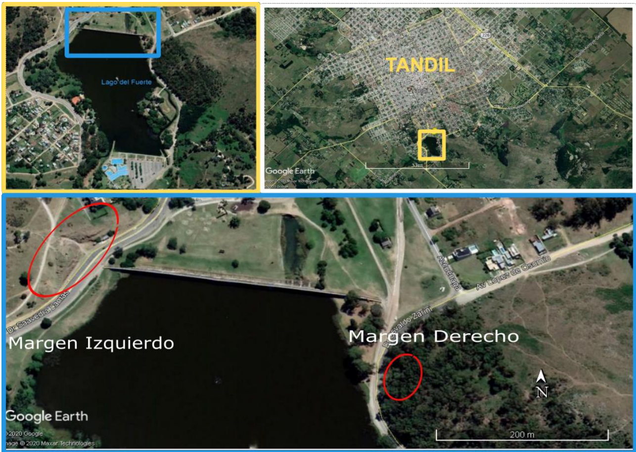
Figura 21.- Ubicación de la presa del arroyo del Fuerte. En rojo se señalan los afloramientos donde se realizó la parametrización de macizo rocoso.
