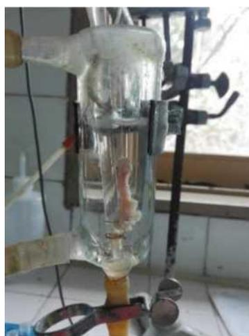
**Figura 9:** Foto de una cuba termostatzada de doble camisa en cuyo interior se encuentra montado un duodeno aislado de rata, el que se encuentra sujeto a un transductor de fuerza. El preparado se encuentra sumergido en solución Tyrode y aireado.
