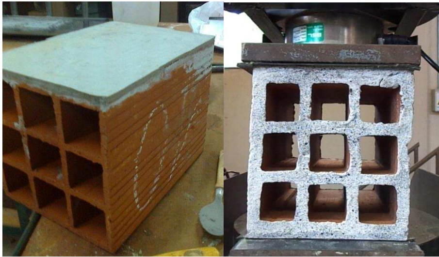
Figura 1: Izquierda: Encabezado de probetas de ladrillos. Derecha: Probeta preparada en máquina de ensayo a compresión.
